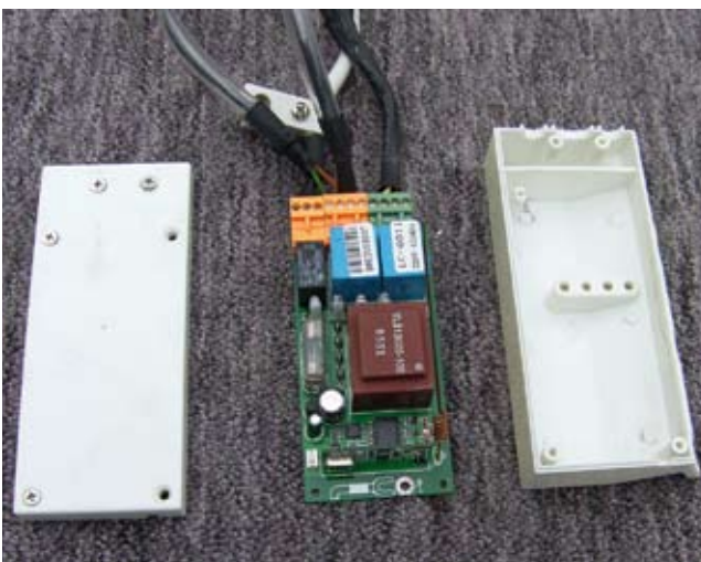
Schutzgehäuse der Steuerung ohne jede Abdichtung.
