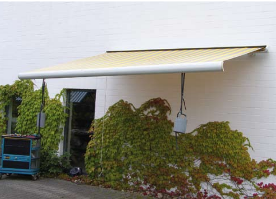
Belastungstest nach Windklasse 2 und DIN EN 13561 / DIN1932.
