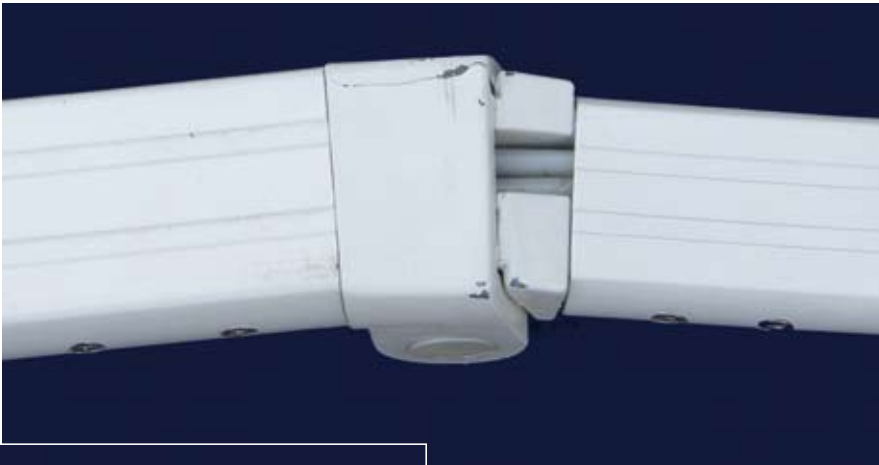
Bruch des Mittelgelenks durch unkontrolliertes Herausfahren der Markise.
