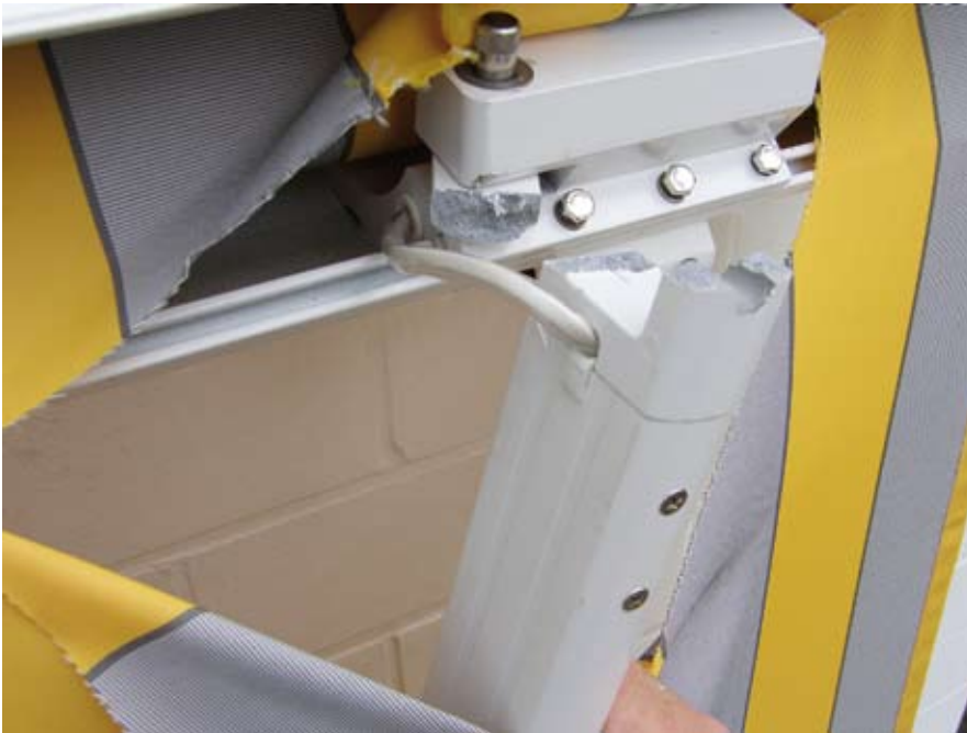
Ursache: Materialbruch in der Gabel des Oberarmgelenks.
