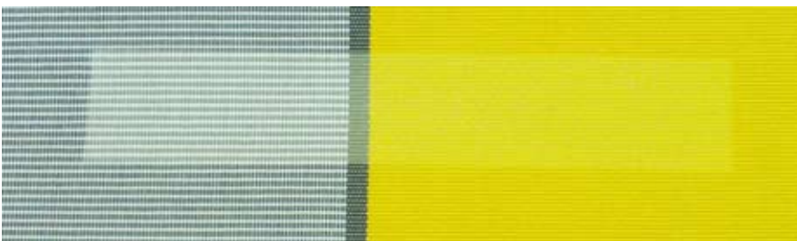
Deutliche Farbunterschiede nach dem Bewitterungstest auf Wetterechtheit nach ISO 105 B04 auf dem Markisentuch sind bereits nach 500 Std. im Xenotester zu erkennen.
